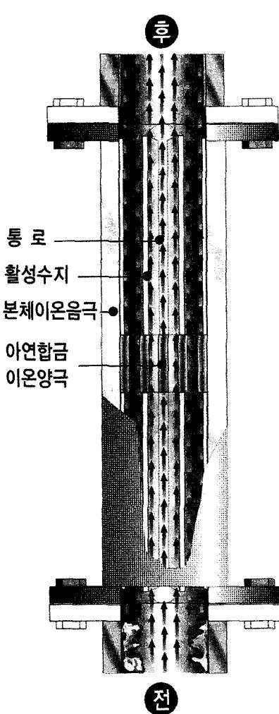
이온 스케일 버스터는 배관 중간에 연결하여 설치하므로 시공이 간단할 뿐만 아니라 별도의 공간을 차지하지 않고 기존 시설의 손상 및 복구가 필요없다. 또한 이온 스케일 버스터의 내부 구조가 물의 흐름에 변화를 주지 않도록 설계되었기 때문에 물의 압력과 속도에 전혀 영향을 미치지 않는다.
