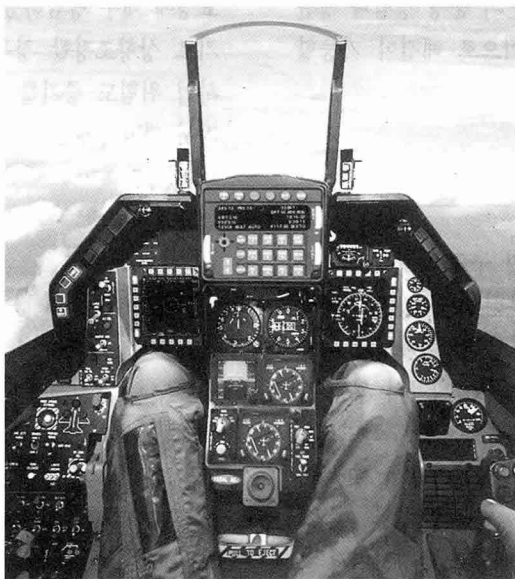
컬러 디스플레이와 HOTAS를 갖춘 T-50의 Digital Cockpit
