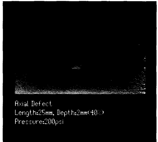
Fig. 17 압력용기의 내부결함 측정 예
