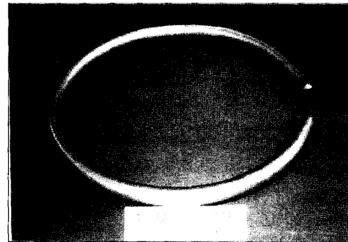
(그림 5) 가열 없이 상온 360도 굽힘 공정 종료 후 Ti-6Al-4V 이음매 없는 튜브
