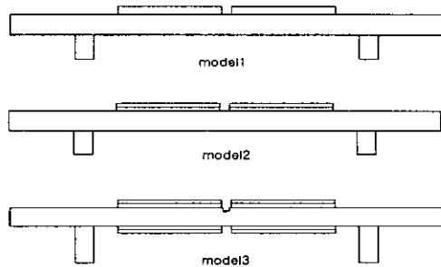
그림 3 L<sub>1</sub>-B<sub>4</sub> 고정진동자의 3가지 모델Fig. 3 Three model of L<sub>1</sub>-B<sub>4</sub> stator vibrator
