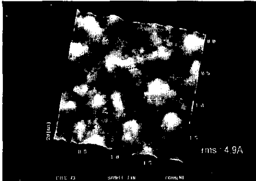
그림 4 - (b) 원 스텝 TiSi 2 의 AFM 도 (AFM images of one step TiSi 2 surface)
