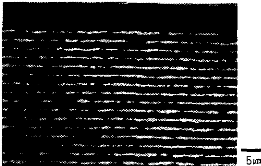
그림 2 3216SIZE X7R 특성 10µF MLCC 내부구조
