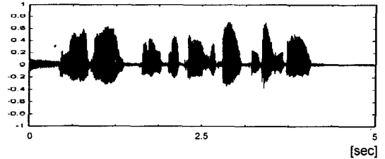
그림 10. 20차 FIR필터의 경우 시스템출력 Fig. 10. System output with 20th order FIR filter
