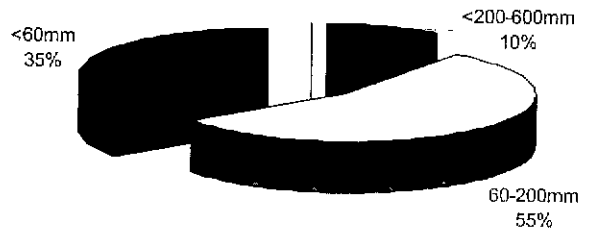
그림 10. 봉락터널의 절리간격에 따른 분류
