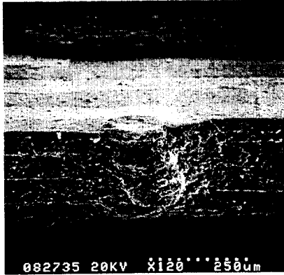
그림 6 비아 contact SEM 사진 Fig. 6 SEM of the via contact
