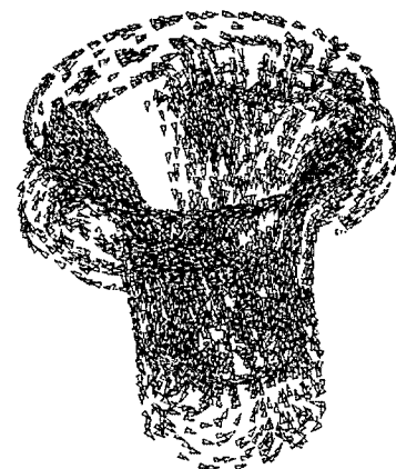
그림 8 코일의 전류 분포 Fig. 8 Current distribution of coil
