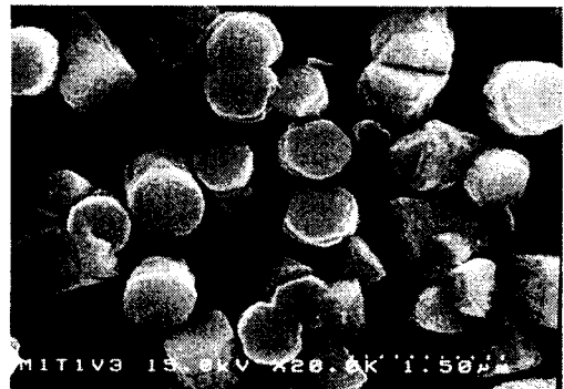
그림 2. 온도 60°C, 질산아연 용액 농도 0.1mol/liter 이고, 전착전위 (a) -0.65, (b) -0.70, 및 (c) -0.75V에서 성장된 ZnO 박막의 SEM 사진.
