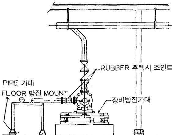
는 SH-타입 방진행가를 사용하고 이 때 스프링의 고유 진동수가 4Hz 이하가 되게 하고 감쇠계수가 좋은 RUBBER MOUNT가 부착된 행가를 사용하는 것이 좋다. 행가 설치시 유의할 점은 상부 천장 스라브 고정점으로부터 하부 가대 고정점까지 수직이 잘 맞아 진동의 간접효과가 없게 해야 한다. 공동가대나 행가는 가능하면 보나 기둥 등에 설치하는 것이 바람직하다.
