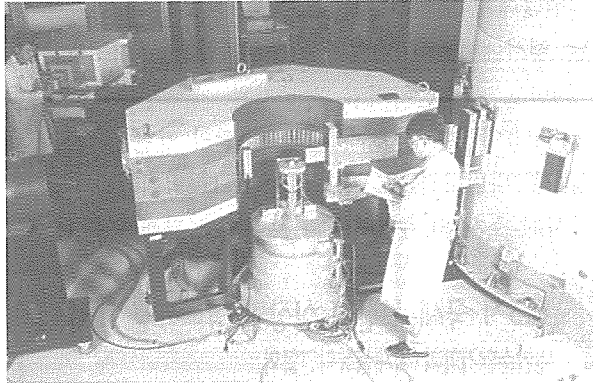
▲ 고분해능 중성자 회절장치를 이용하여 물질의 구조를 분석하고 있는 모습
