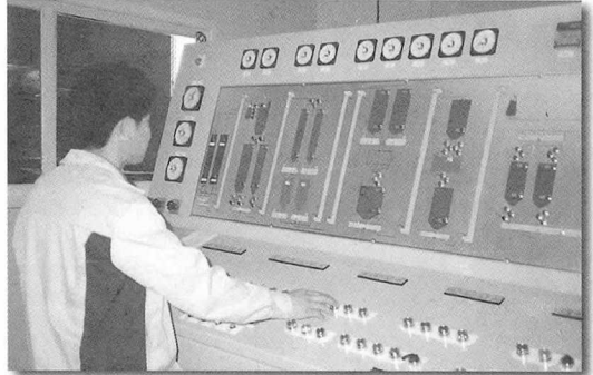
▲공장 직원이 사료생산 전과정을 컴퓨터를 이용해 자동으로 조절하고 있다. 이 공장은 4명의 생산직원만으로 배합사료를 생산해 내고 있다.
