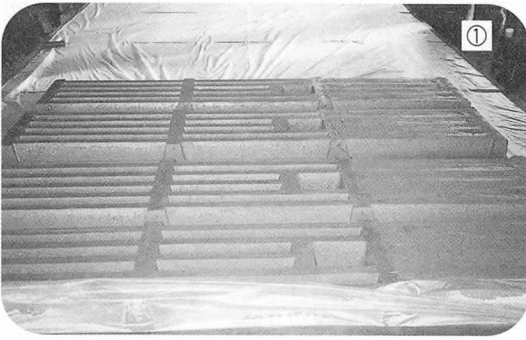
① 완성되어 나온 콘스라트, 합판 바닥에 비닐을 깔고 그 위에다가 제품을 놓는다. 여기서 비닐이 하는 역할은 수분이 합판으로 스며드는 것을 방지하는 역할을 한다.
