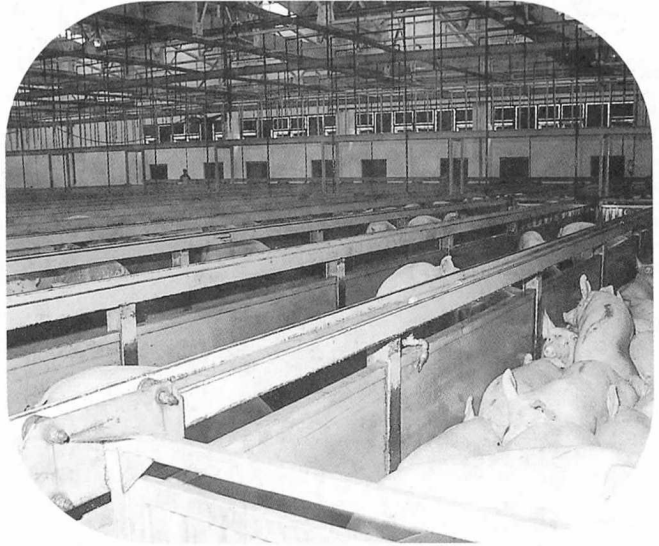
▲계류장의 돼지의 적정 수용밀도는 0.55~0.67m 2 /두로 알려져 있다. 계류장은 밝은 것보다 어두운 것이 좋으며, 돈방은 좁고 긴 장방형이 권장된다.
