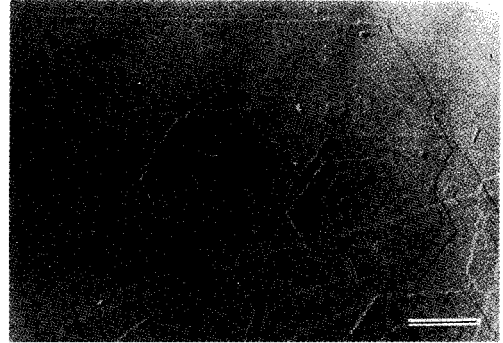
그림 3. Electron micrograph (1 \mu\text{m} scale bar) of PTMS lamella crystallized at 65 °C.
