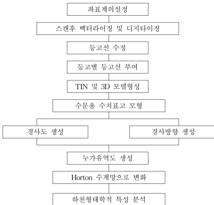
그림 1. GIS시스템을 이용한 하천형태학적 특성분석 흐름도
