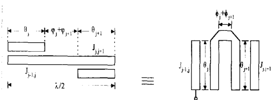
그림 6. 결합선로 형태의 인버터와 hairpin 형태의 인버터 회로 Fig. 6. Inverter configuration of the coupled line and hairpin type configuration.
