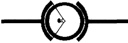
그림 12. 결합 선로를 갖는 링 공진기 구조 Fig. 12. Structure of ring resonator with coupling line.
