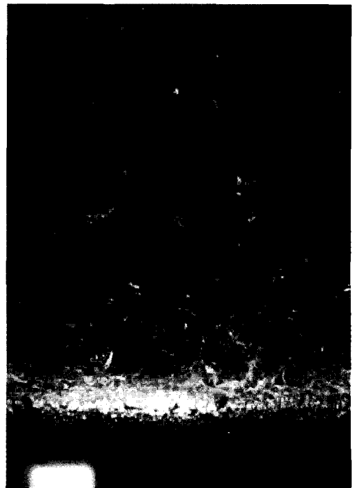
(d) q'' = 853.06 \text{ kW/m}^2 \Delta T_s = 16.99^\circ\text{C}
