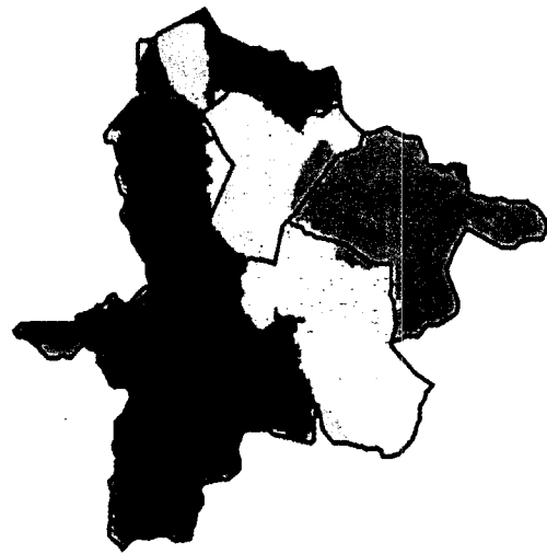
그림 24. 표고와 하천에서 자동 추출한 유역과 수작업에 의한 유역과의 중첩
