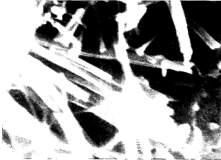
Photo 1. Ettringite (SEM for test pile P6)
