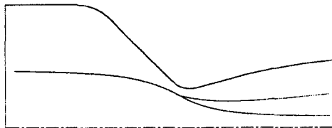
Fig. 4 Droplet trajectories for Stk=11.3 ( d_p=100 \mu m ).
