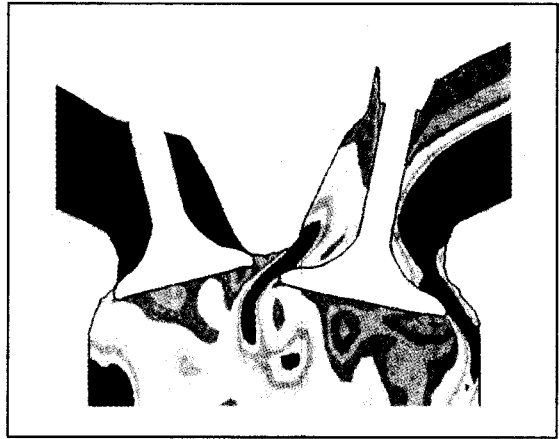
〈그림 2〉 흡입 행정시 밸브 주위의 비정상 유동 속도 분포 계산의 예
