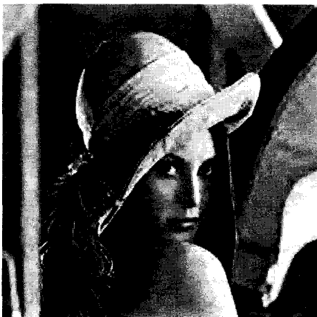
그림 12. 제안한 방법으로 64:1로 압축한 Lena 영상 Fig. 12. Compression result at 64:1 by the proposed method
