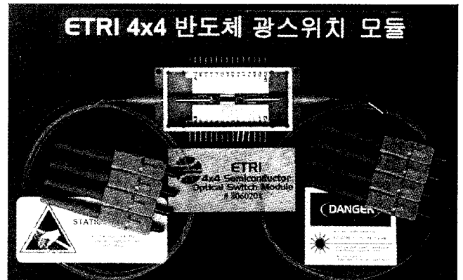
그림 7. 완성된 4x4 스위치 모듈 사진.
