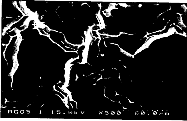
그림 4 430°C 활성화한 경우 MgO 표면의 크랙 사진 Fig. 4 SEM photo of MgO surface cracks after 430°C activation for 1hr
