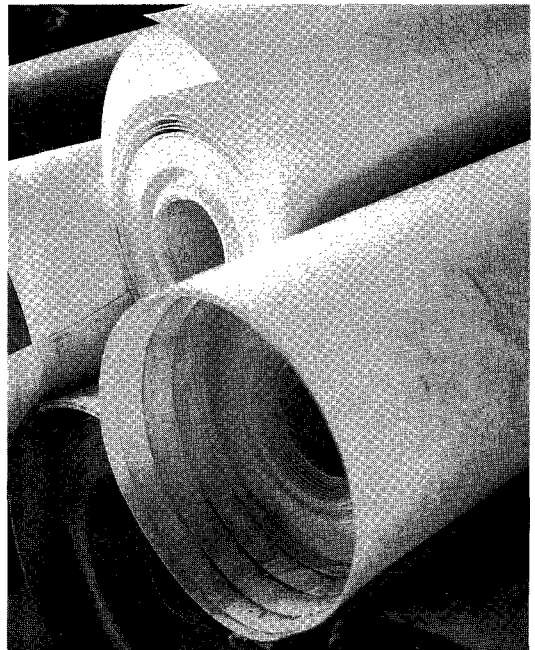
△ 계분벨트는 플라스틱(PP)으로 되어있기 때문에 닭이 들어있지 않은 상태에서 겨울철에 작동시킬 경우 파손율이 높아 사용하는데 주의를 기울여야 한다.
