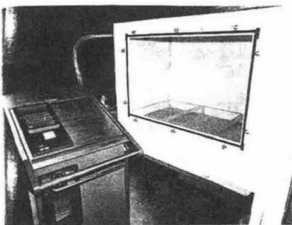
그림 1. AMSCO VHP 1000 Biodecontamination System and 30-ft 3 treatment chamber(ARS design)
