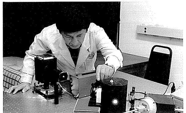
▲ 정밀한 색체의 측정을 위한 절대분광반사율 측정 시스템
