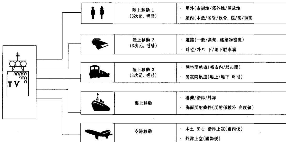
<그림 2> 이동통신(移動通信)에 있어서의 전파 전반(電波傳搬)의 분류(分類)
