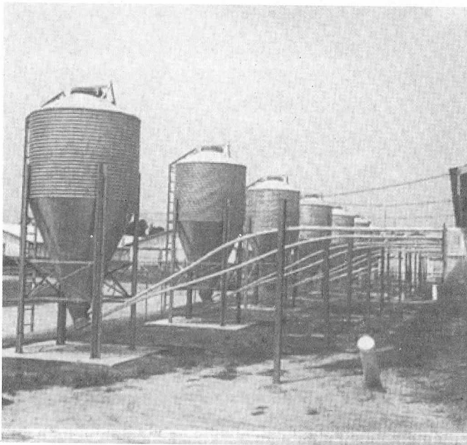
▲사료를 각 돈사로 이송하기 위한 컨베이어를 설치한 사료 저장고, 사료 저장고가 농장 경계선을 따라 설치된 것이 특징이다.
