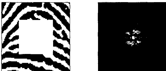
2) 지문의 80×80에서 40×40제거후 주파수 특성 그림14. Arch형의 부분 블록에 의한 주파수 특성
