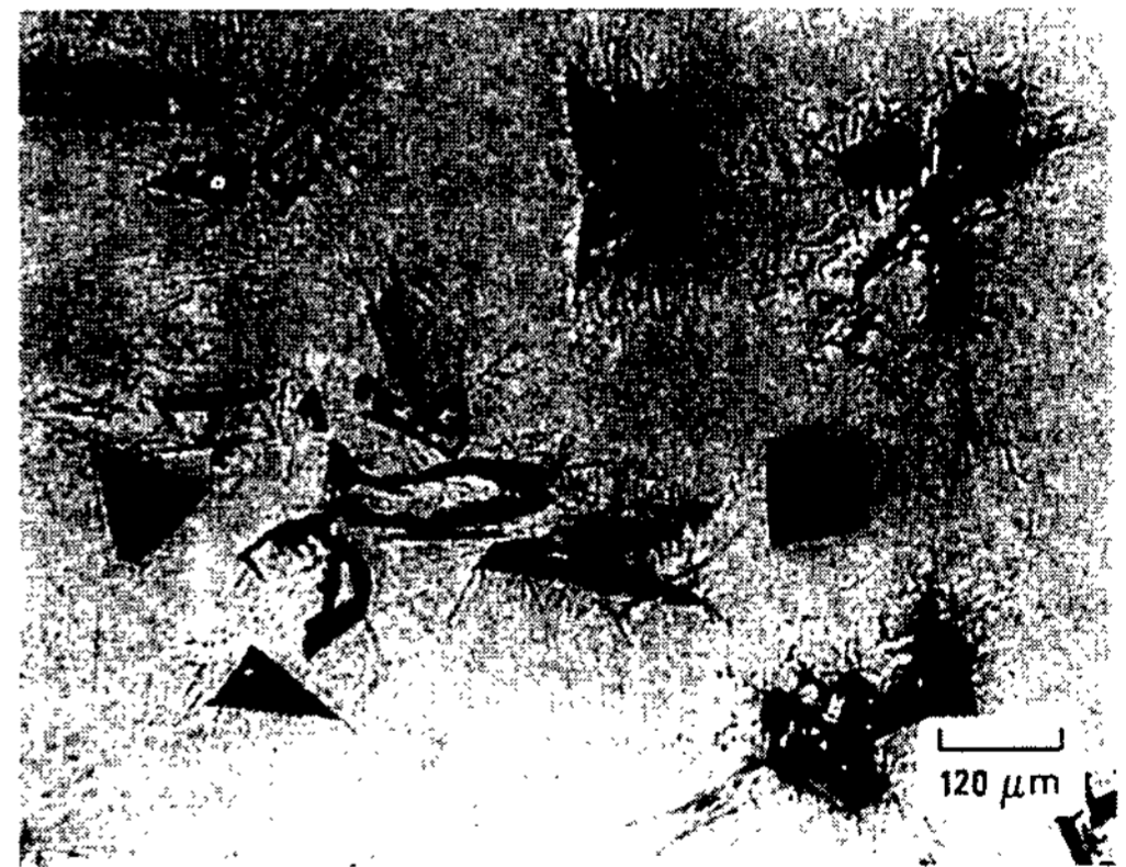
그림 5. 29°C/sec의 속도로 응고된 Al-17% Si 합금에서 발견되는 전형적인 조직.
