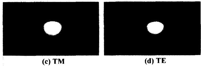
그림 12. 도파로 도파모드, 7 μm.
