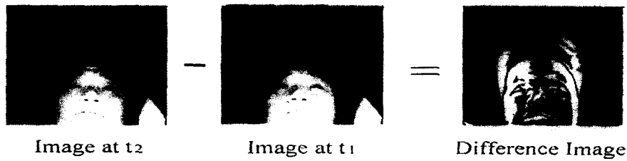
그림 3. 이미지 명암차의 이진화 Fig. 3. Getting binary image from the difference between two image
