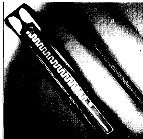
그림 18. 제작된 구동기와 직경 0.5mm 스프링의 비교
