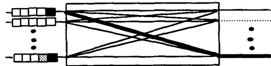
(그림 3-1) 입력 큐잉 방식 스위치 블록도
