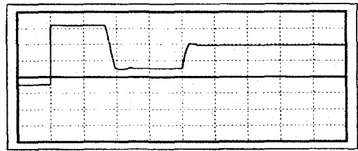
(X축: 0.5 sec/div, Y축: 2.5A/div) (a) 토오크 성분 전류 지령치 (a) Reference current of torque component
