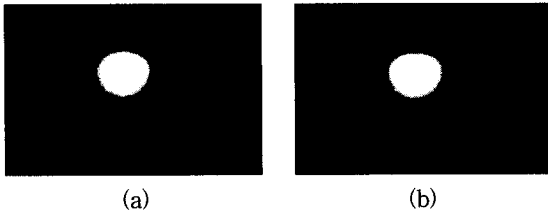
그림 13. 도파로 도파모드 (a) TM/TM (b) TE/TE Fig. 13. Waveguide mode. (a) TM/TM (b) TE/TE
