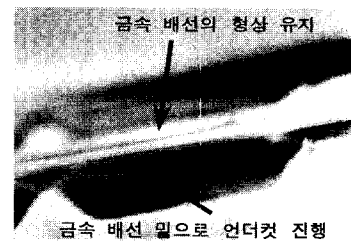
그림 3. 등방성 습식 식각에 의한 언더컷 실험 결과 (a) 습식 식각후 측정된 금속의 단면 SEM 사진 (b) 상부의 금속 배선을 제거한 후 측정된 SEM 사진 Fig. 3. The results of undercut experiment by isotropic wet etching. (a) A schematic picture measured by SEM after wet etching (b) A SEM picture measured after removing the metal line.
