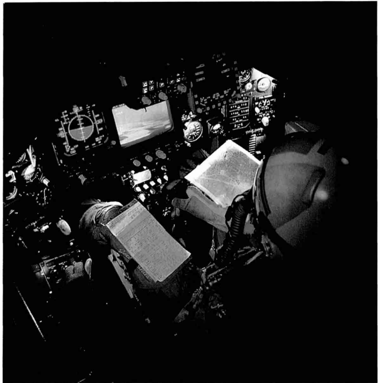
F-117 스텔스기의 조종석. 전방의 대형 칼라 화면을 통해 4-D flight control system에서 전해지는 실시간 정보를 살펴 볼 수 있다
