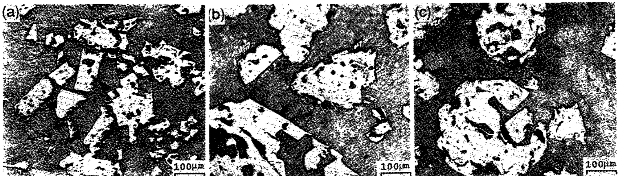
그림 6. 800°C에서 580°C까지 5°C/분의 속도와 200 rpm의 교반속도의 연속 냉각교반시 초정 Si의 형상변화: (a) 700°C; (b) 650°C; (c) 580°C.
