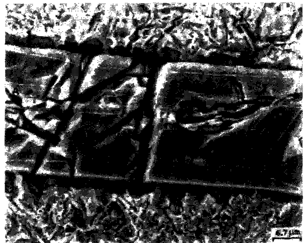
그림 9. 5°C/분의 속도와 200 rpm의 교반속도로 연속 냉각 교반 중 700°C에서 얻어진 미세조직에 대한 주사전 자현미경 영상.
