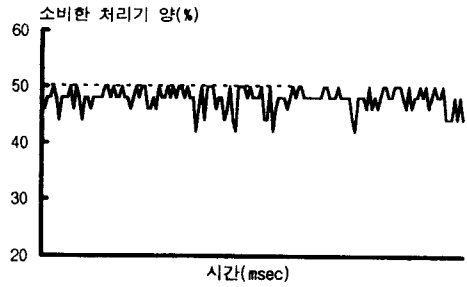
(그림 13) 6 Mbps의 전송률을 가지는 프로세스를 계산 중심 응용 프로그램이 소비한 처리기 시간 (Fig. 13) Processor time that the compute-bound application consumes when one process transfers data at 6 Mbps
