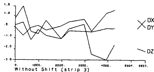
그림 8. GPS 관측값의 shift, drift 소거 후의 오차분석도
