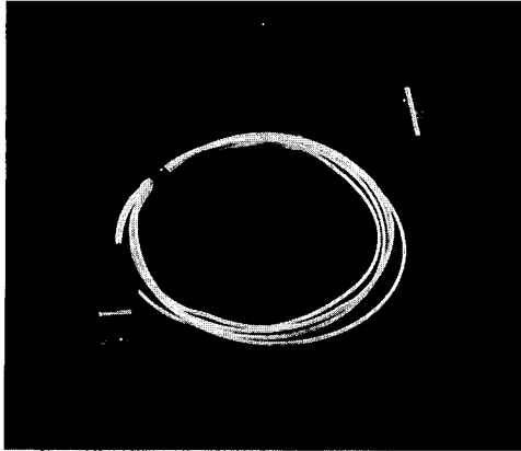
그림 28. Photograph of a single mode fiber pigtailed 1.3 μm PBH laser.
