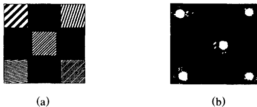
그림 12. SLM에 디스플레이된 격자 배열과 출력평면에서의 연결 결과 (a)스위칭을 위한 격자배열 (b)실험결과(출력포트 1, 3, 13, 21, 25)
