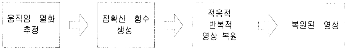
그림 1. 적응적 반복적 복원 기법을 이용한 움직임 열화 제거 기법 블록도
